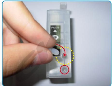
**PASO 05** Colocar los cartuchos en la impresora. Recuerde **DEJAR DESTAPADO EL ORIFICIO QUE SE ENCUENTRA DESTACADO EN VERDE EN LA IMAGEN DEL PASO 4**. Así Ya podrá imprimir.**ATENCIÓN:**
